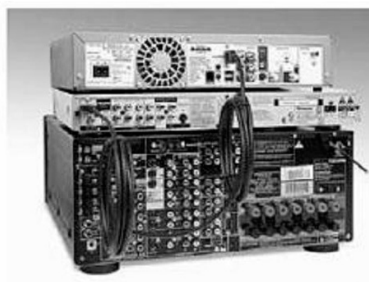
〈그림 6〉 HDMI 케이블을 이용한 간단한 AV 배선
